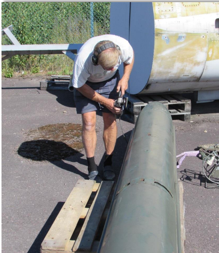
Antero i full gång med slipmaskinen för att få bort rosten..
